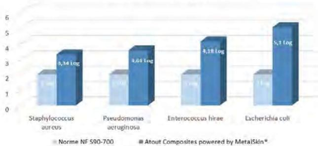
Source : Test de conformité Atout Composites powered by MetalSkin® selon norme NF S90-700 conduit par le Laboratoire Fondrephar Toulouse (06/2020)
